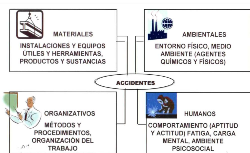
Gráfica 1. Identificación de Peligros que causan Accidentes Laborales
